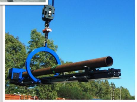
IDROJET PROUDLY ANNOUNCES THE BORN OF THE FIRST "PULL & PUSH" SUPER LIGHT BUNDLE PULLER SUITABLE FOR BOTH TUBES AND TUBE BUNDLES WITH A MACHINE WEIGHT OF ONLY 2000 KG.
